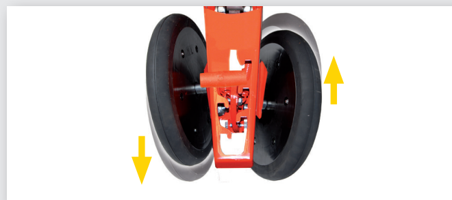
Desalineación de las ruedas Mejora el paso de los residuos y de la tierra entre las ruedas, minimizando el riesgo de acumulación de cuerpos extraños
